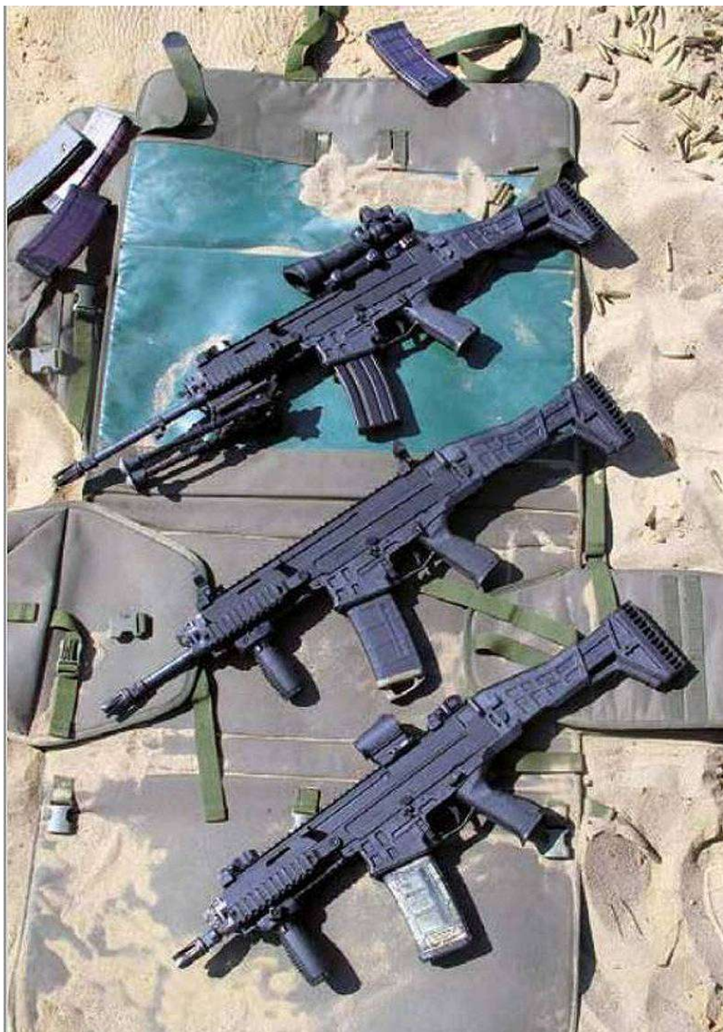
Брен 2 в разных конфигурациях: (сверху вниз) со стволом 14 дюймов, со стволом длиной 11 дюймов и со стволом 8 дюймов
