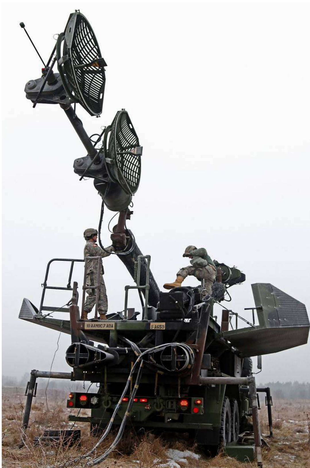
Оператор управления огнем и технические специалисты MIM-104 Patriot сворачивают мачту с антеннами во время тактических учений Panther Assurance, проходивших в январе этого года в Польше
