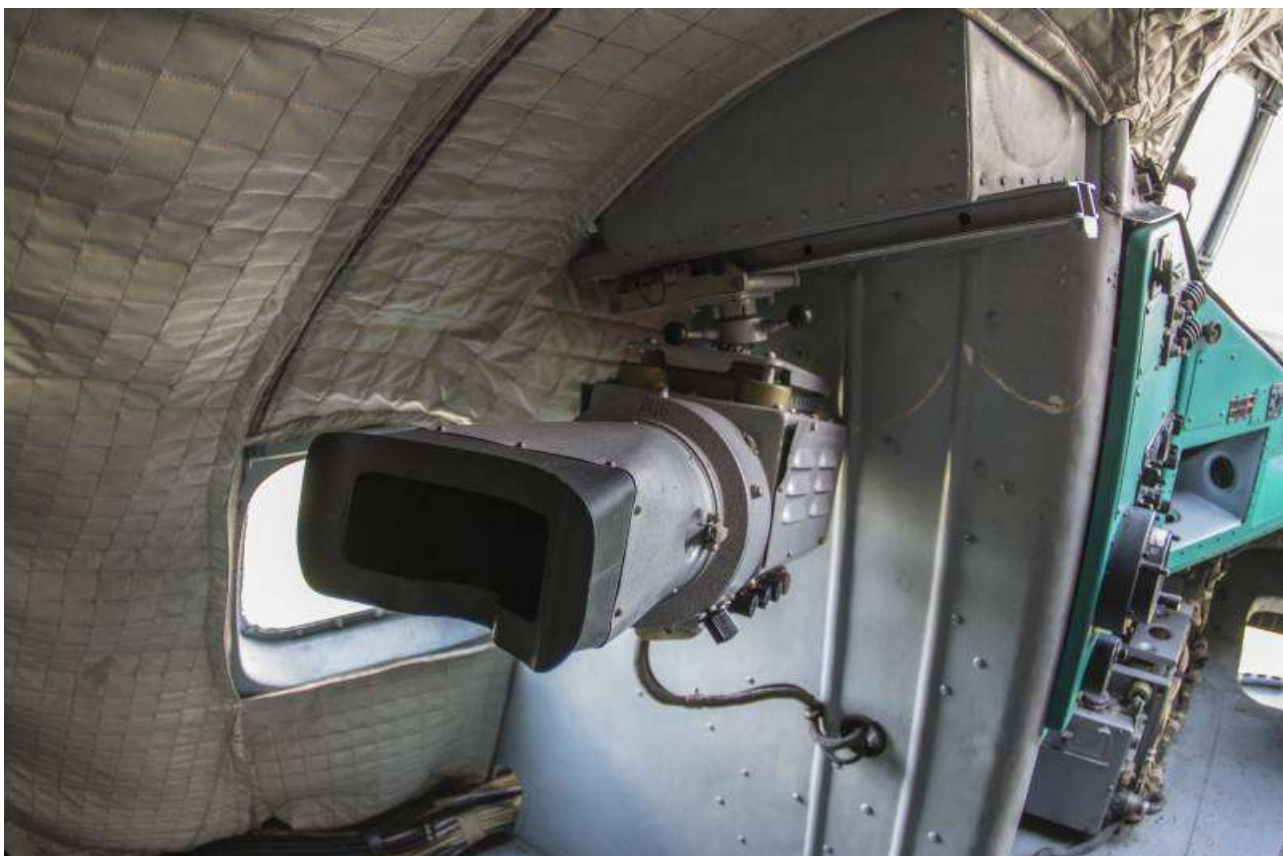
Сверхнововведение для 60-х годов прошлого века. Это визир камеры вертикального обзора для посадки в плохоосвещенных местах.
