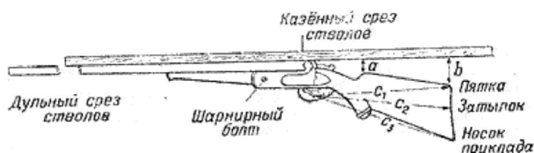
Рис. 11. Данные ложи: линия C_2 определяет длину ложи; линии a и b определяют изгиб шейки ложи, ее крутизну; линии C_1 и C_3 определяют форму затылка приклада (на рисунке показана общепринятая средняя нормальная форма)
