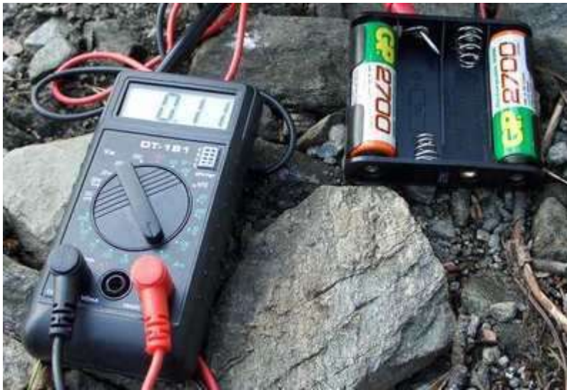
Рис.8. Ток зарядки 2 шт AA аккумуляторов под плотным облаком.
