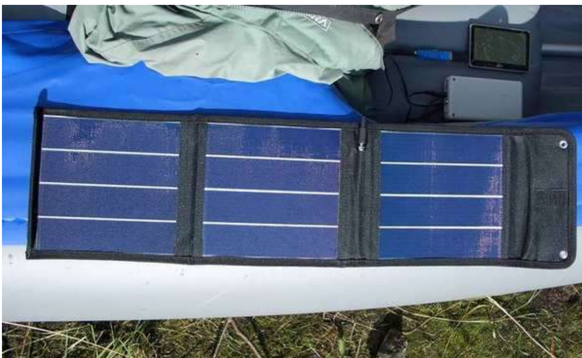
Рис.4. Зарядка навигатора напрямую от солнечной батареи через кабель-стабилизатор и USB переходник.
