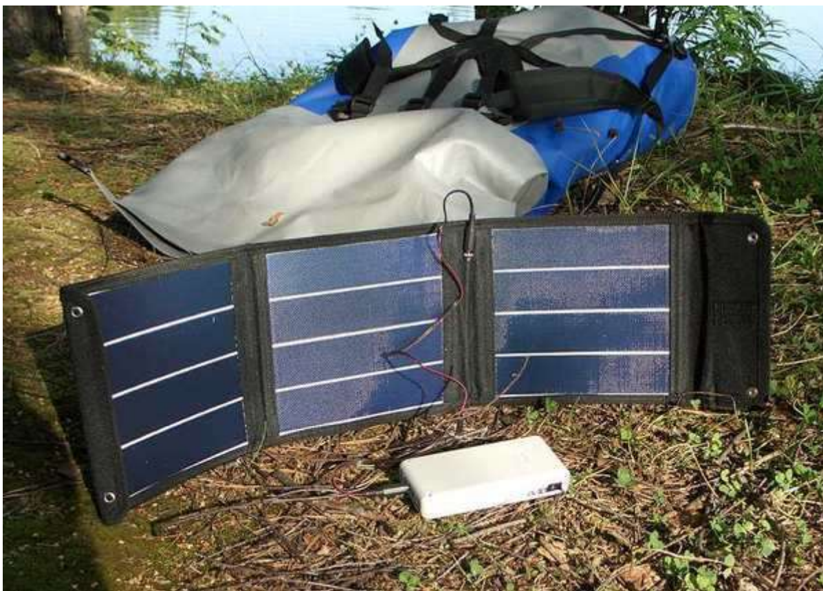
Рис.2. Солнечная батарея заряжает "Вампирчик".
