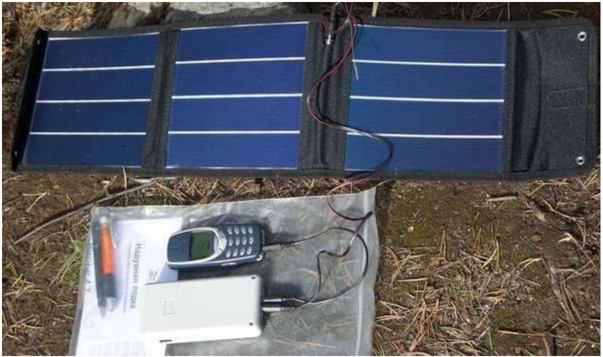
Рис.14. Зарядка сотового телефона от "Вампирчика" через переходник.
