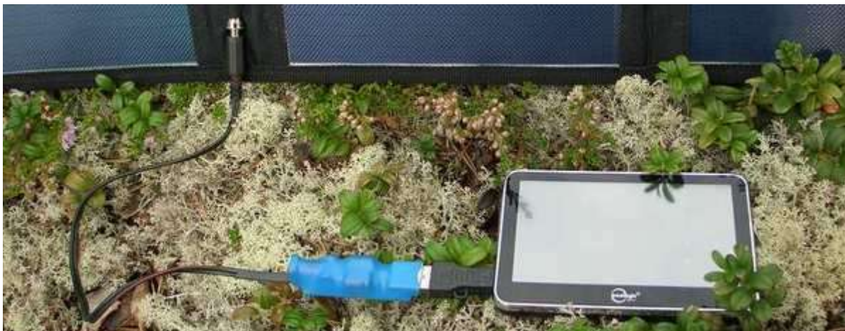
Рис.4. Зарядка навигатора напрямую от солнечной батареи через кабель-стабилизатор и USB переходник.
