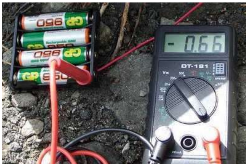
Рис.9. Зарядка 4AAA аккумуляторов напрямую от солнечной батареи SC-6/6.
