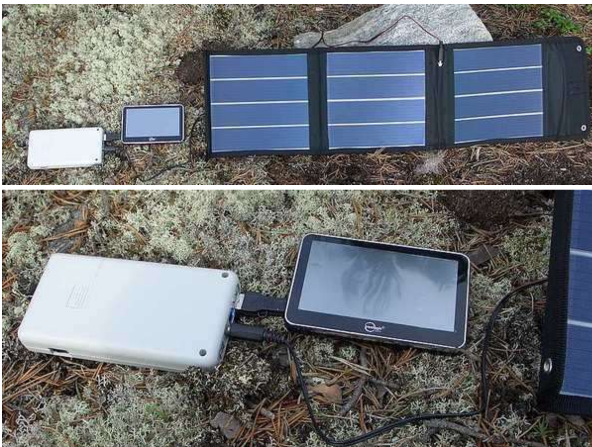
Рис.3 Одновременная зарядка "Вампирчика" и навигатора.
