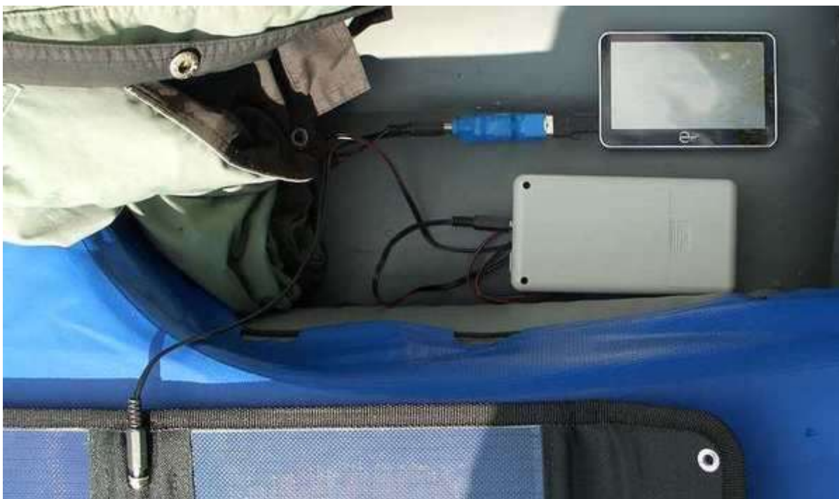
Рис.5. Зарядка навигатора через кабель-стабилизатор и параллельная зарядка "Вампирчика".
