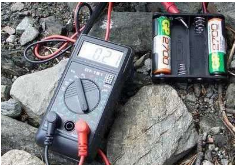
Рис.7. Ток зарядки 2 шт. последовательных АА аккумуляторов под облаками.
