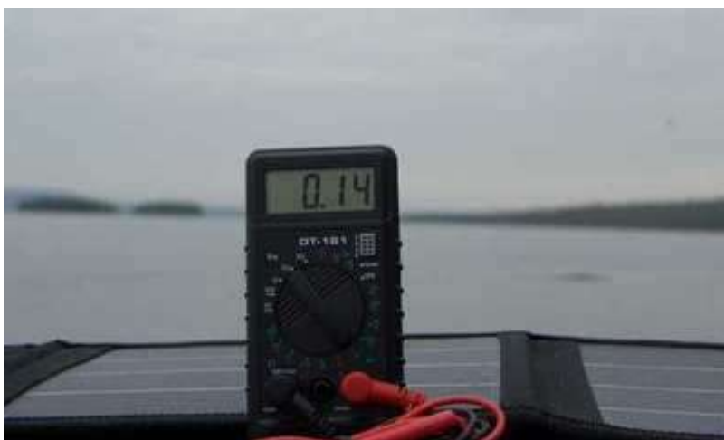
Рис.11. Ток короткого замыкания солнечной батареи.
