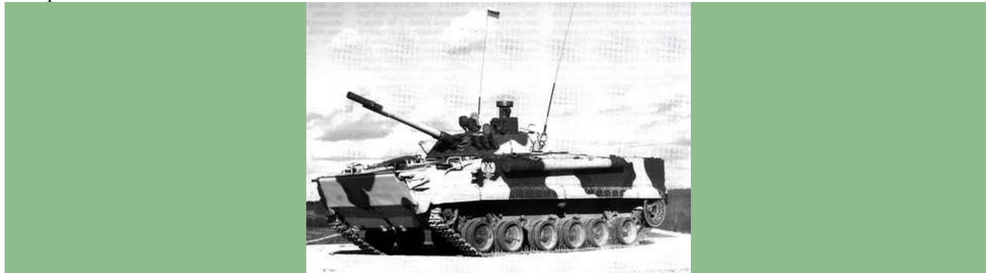
Боевая машина пехоты БМП-3 с прицельным комплексом "Весна-К"
