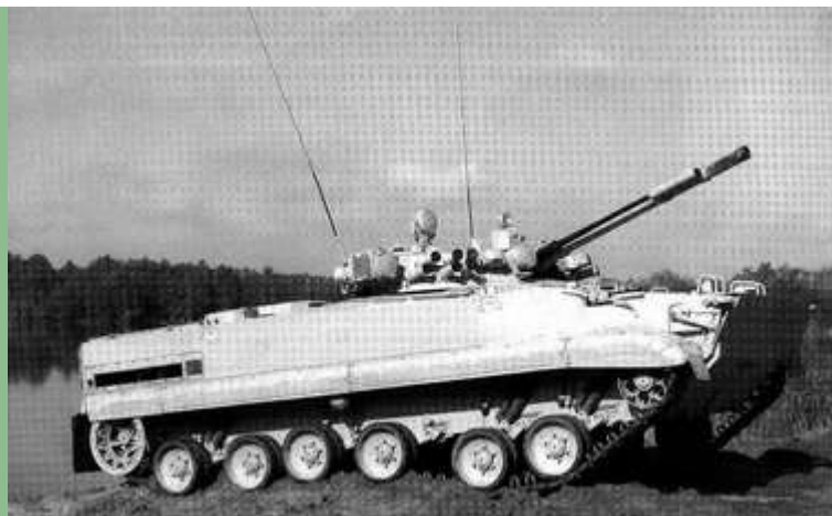
Модернизированная боевая машина пехоты БМП-3 с системой "Штора-1"
