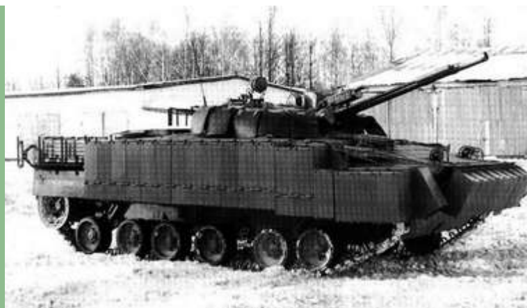
Боевая машина пехоты БМП-3 с установленными блоками динамической защиты
