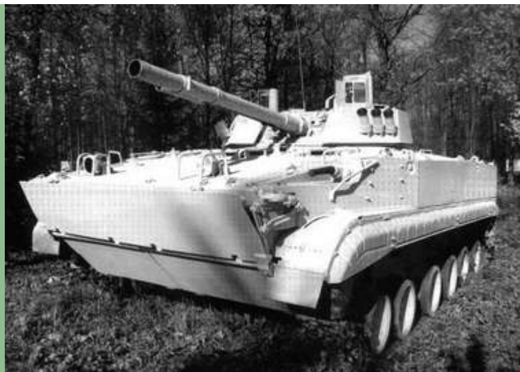
Боевая машина пехоты БМП-3 с боевым модулем "Бахча-У"
