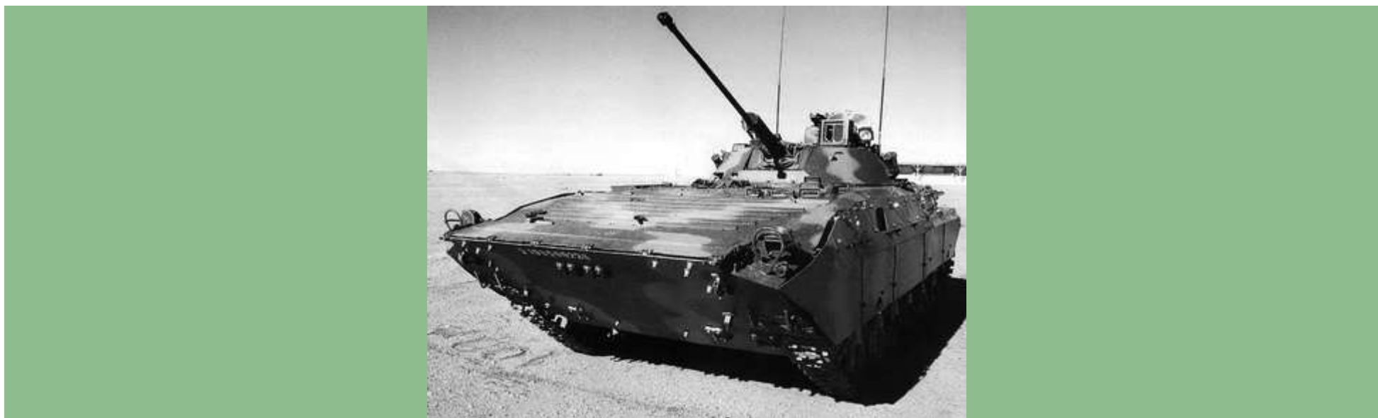
Модернизированная в Беларуси БМП-2 с прицелом "Рубеж-М" и усиленным бронированием бортов
