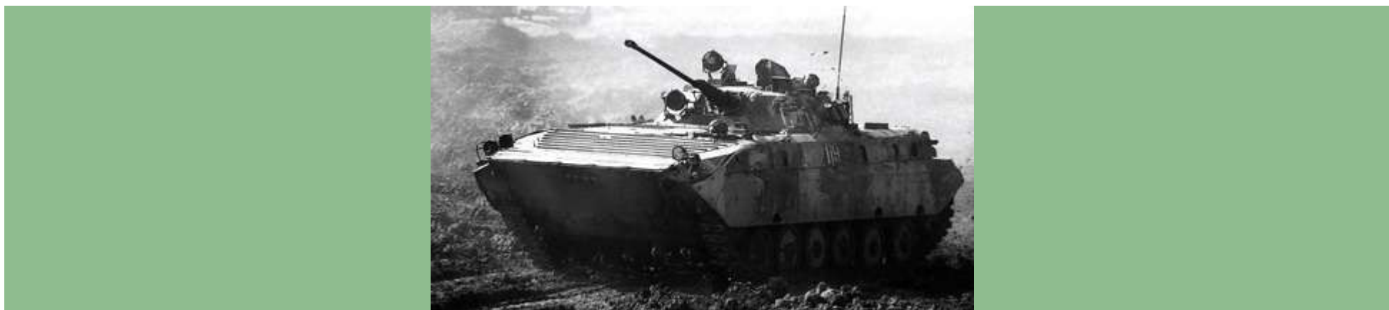
Боевая машина пехоты БМП-2Д с дополнительным бронированием бортов
