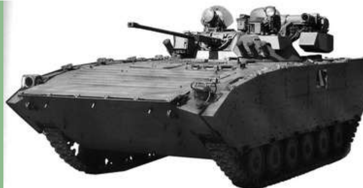
Модернизация БМП-2 установкой АГС-17, двигателя УТД-23, новой СУО, усиленным бронированием (Курган)
