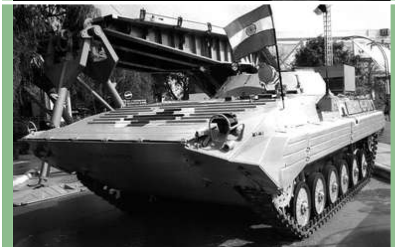
Индийский вариант бронированной медицинской машины AAV, созданной на базе БМП-2
