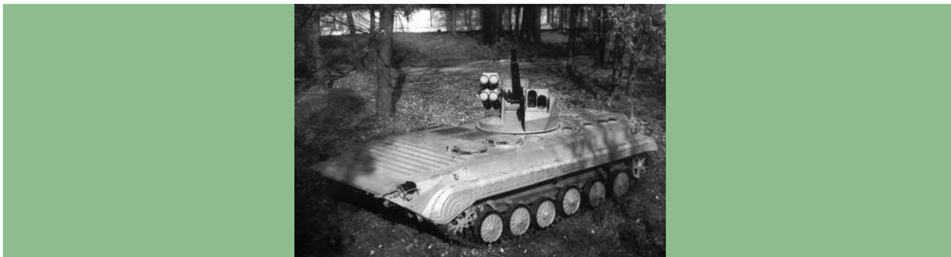
Боевая машина пехоты БМП-1 с боевым модулем "Кливер"
