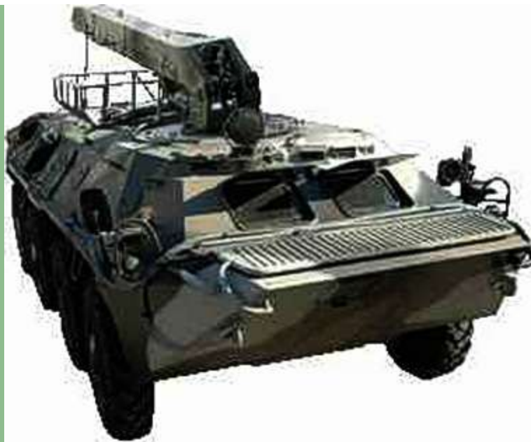
БРЭМ-7К - бронированная ремонтно-эвакуационная машина на базе БТР-70ДИ, украинская модификация БТР-70
