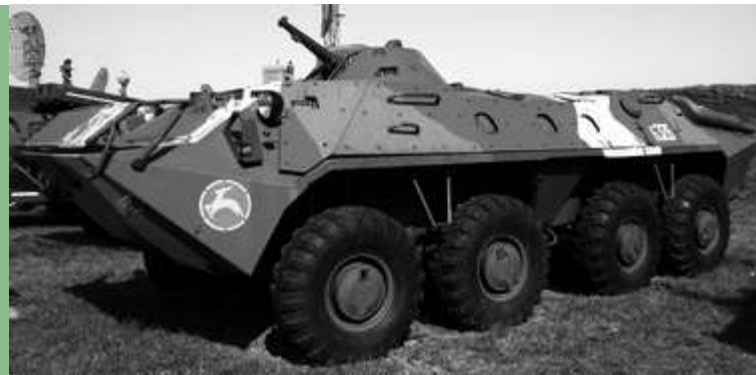
Бронетранспортер БТР-70 с дополнительным бронированием
