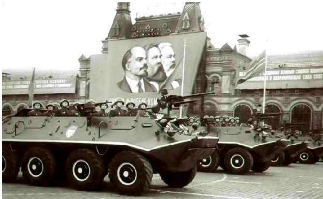
БТР-60П и БТР-60ПА выполнялись плавающими, окопходными, отличались лучшей проходимостью и защитными свойствами. Бронекорпус каждого из них делился на четыре отделения: управления, десантное (боевое), силовой установки и трансмиссионное. Боевое отделение БТР-60П было рассчитано на 14 человек и два человека размещались в отделении управления. Впервые, и в качестве силовой установки, на бронетранспортер были установлены два двигателя по 66 кВт (90 л.с.) каждый, с размещением их в корме машины.
