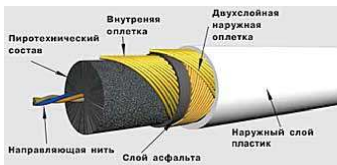
Огнепроводный шнур ОШП в разрезе
