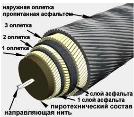
Огнепроводный шнур ОШДА в разрезе
