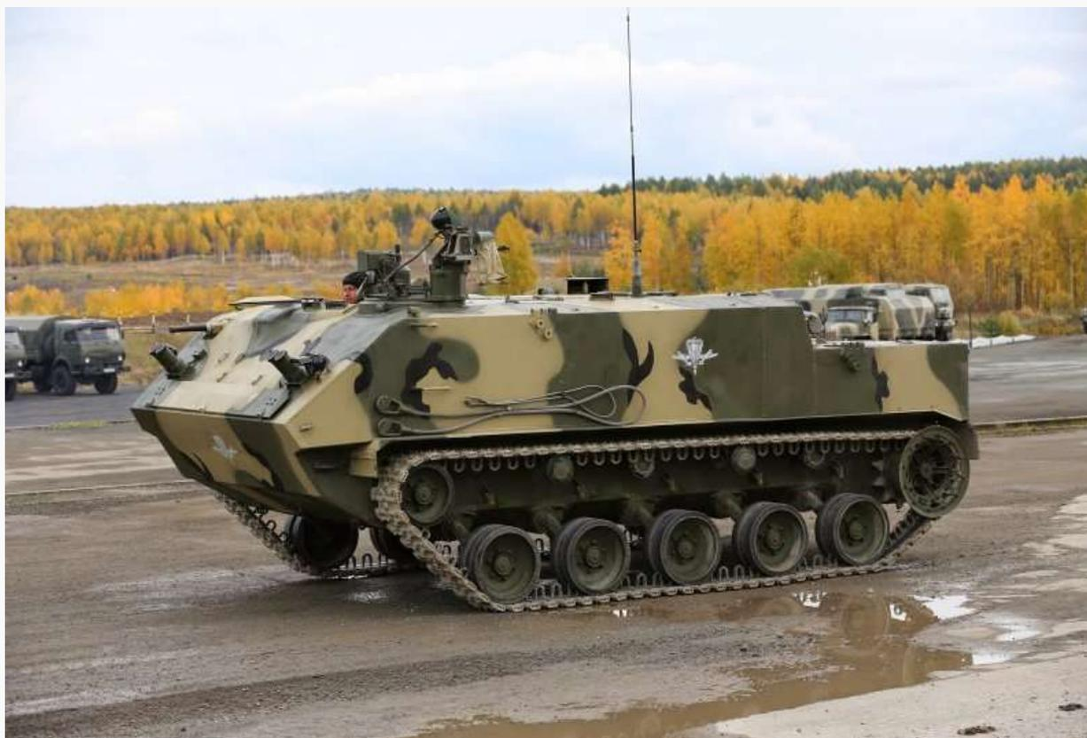
Как и предыдущий бронетранспортер для воздушно-десантных войск, БТР-МДМ имеет легкое пулеметное вооружение. Вооружение машины БТР-МДМ состоит из дистанционно управляемой башенки с 7,62-мм пулеметом ПКТМ. Боекомплект пулемета располагается в ящике рядом с ним. Для наведения пулемета на цель используется перископический прицел 1П67М.
