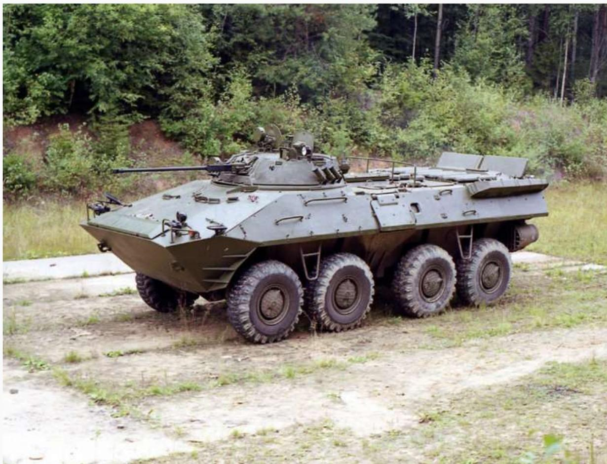
Механизмы башни позволяли наводить оружие на  $360^\circ$  в горизонтальной плоскости и от  $-5^\circ$  до  $+75^\circ$  в вертикальной.
