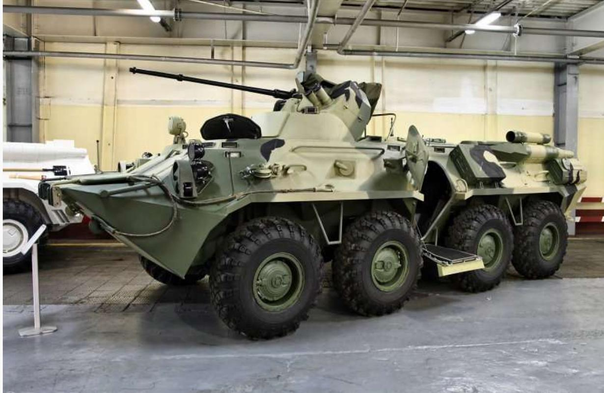
Башня бронетранспортера БТР-80А имеет ряд преимуществ перед предыдущими системами вооружения, но мощь ее оружия может быть избыточной для выполнения некоторых боевых задач. Кроме того, для установки тяжелой башни с автоматической пушкой необходимо дорабатывать корпус базового бронетранспортера.
