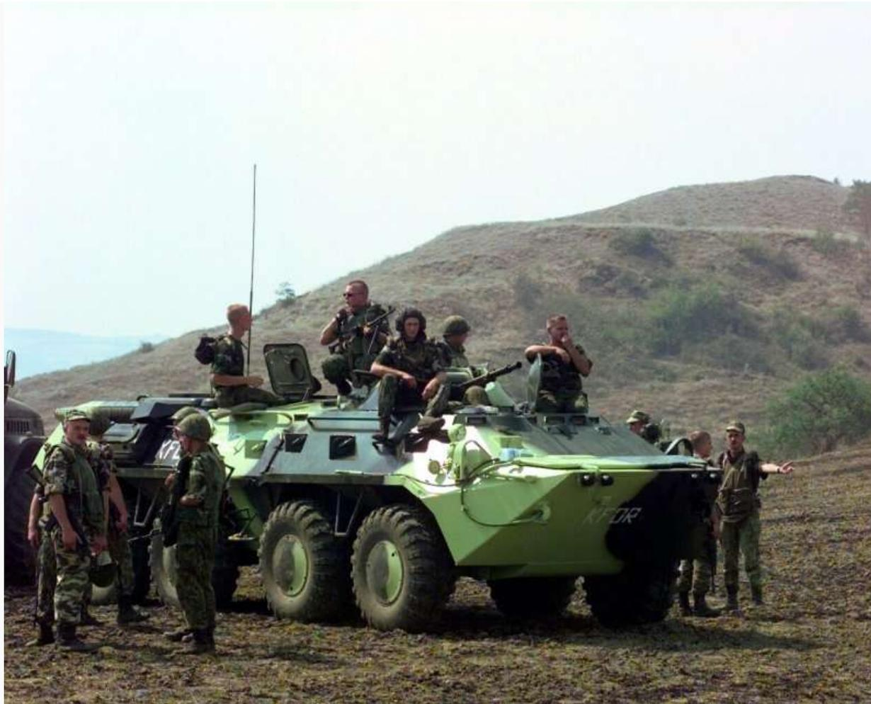
Вооружение и его характеристики остались прежними, хотя конструкция башни претерпела некоторые изменения, связанные с технологией изготовления. Кроме того, в башне бронетранспортера БТР-70 предлагалось устанавливать модернизированный перископический прицел ПП-61АМ. Размеры боекомплекта и дальность стрельбы остались прежними.
