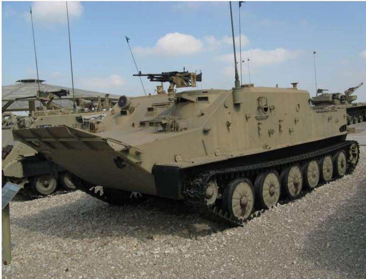
Устройства для установки пулемета СГМБ были унифицированы с агрегатами бронетранспортеров предыдущих моделей. Благодаря этому стрелок машины БТР-50П мог обстреливать достаточно широкие сектора в передней и задней полусферах. Пулемет бронетранспортера использовал ленты на 250 патронов. В возимый боекомплект входили пять лент – 1250 патронов.
