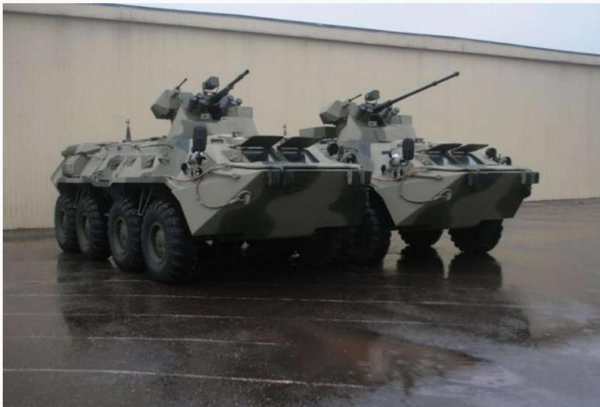
Бронетранспортер БТР-82А несет 30-мм автоматическую пушку и пулемет ПКТ. Вооружение стабилизировано в двух
