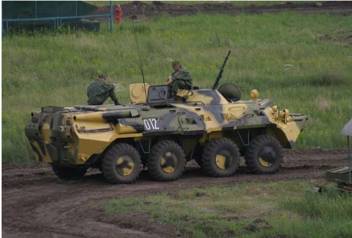
Вооружение первой модификации БТР-80 было заимствовано у предыдущей бронетехники. В башне установили пулемет КПВТ калибра 14,5 мм и 7,62-мм ПКТ. Системы крепления пулеметов претерпели некоторые изменения. Новые механизмы с ручным приводом позволяли наводить пулеметы в вертикальной плоскости в пределах от  $-4^{\circ}$  до  $+60^{\circ}$ .
