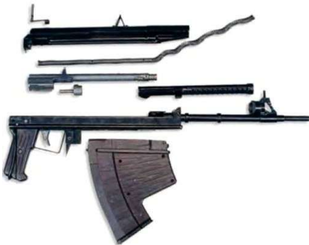
Неполная разборка автомата подводного АПС
