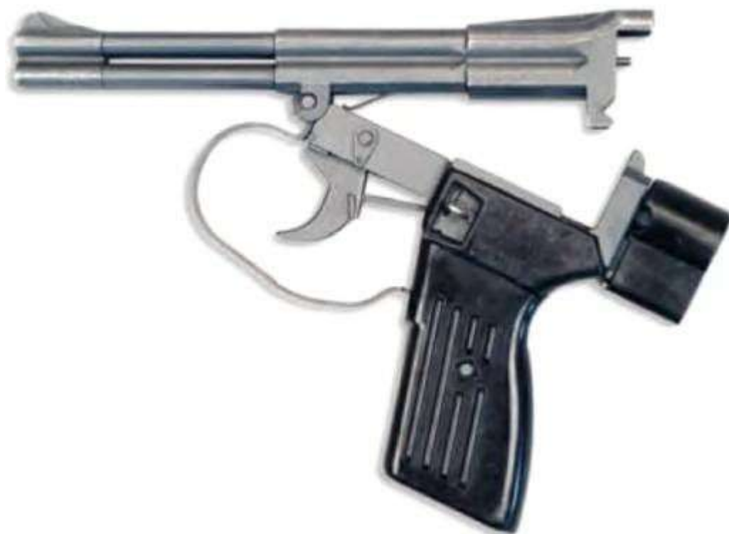
Пистолет СПП-1 М с откинутым для заряжания блоком стволов
