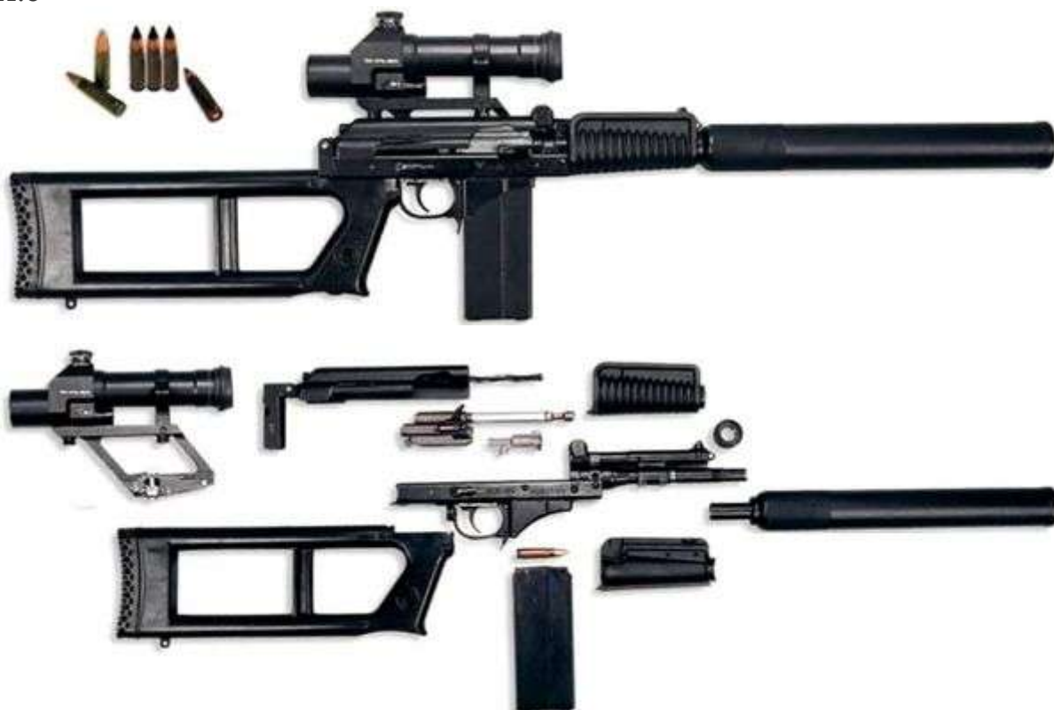
Неполная разборка винтовки ВСК-94, рядом прицел ПКС-07
