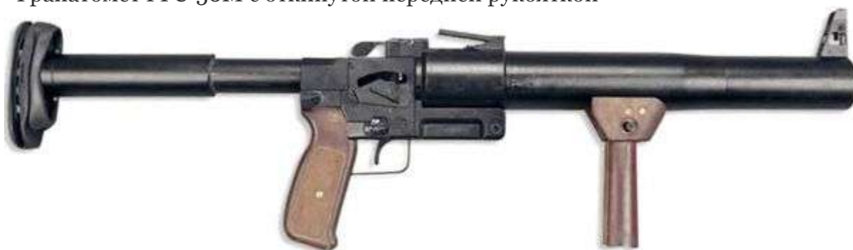
Гранатомет РГС-50М с откинутой передней рукояткой
