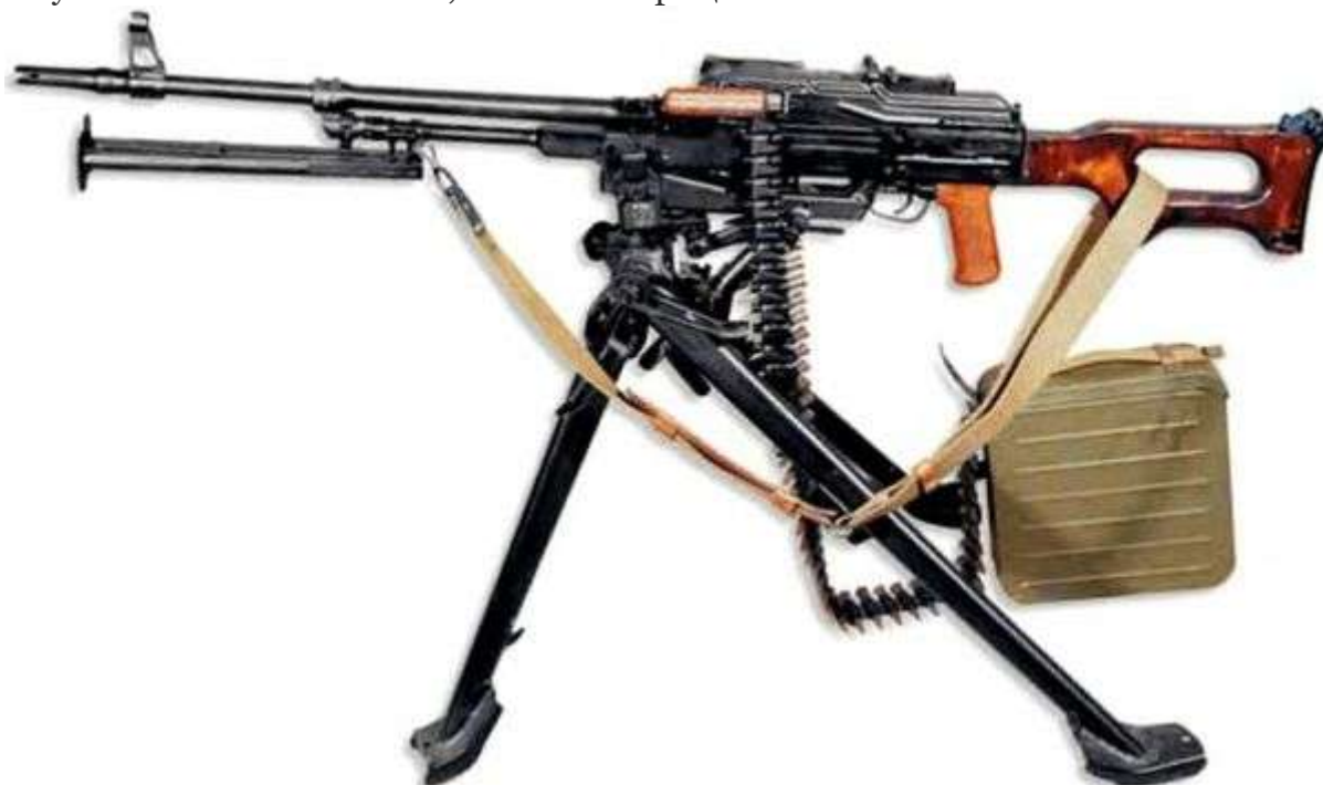
Пулемет ПКМС на станке Степанова в положении для стрельбы по наземным целям
