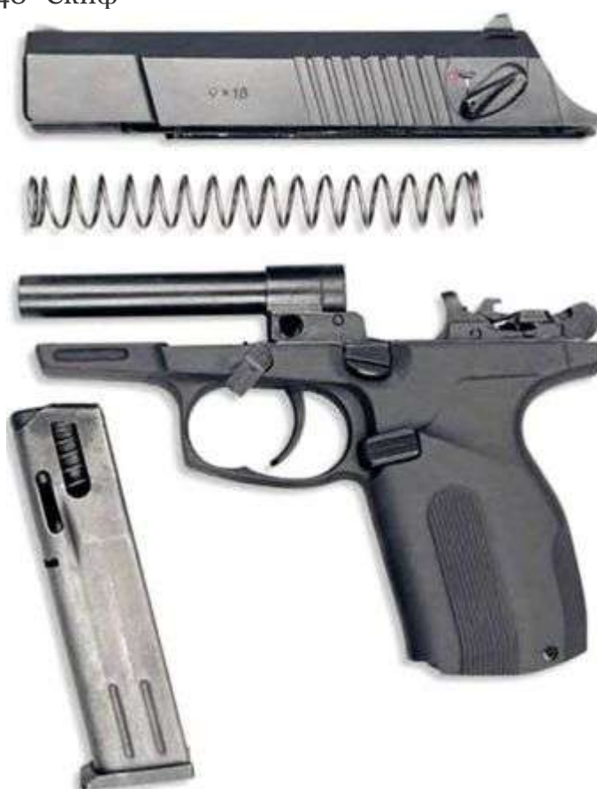
Неполная разборка пистолета МР-448 "Скиф"
