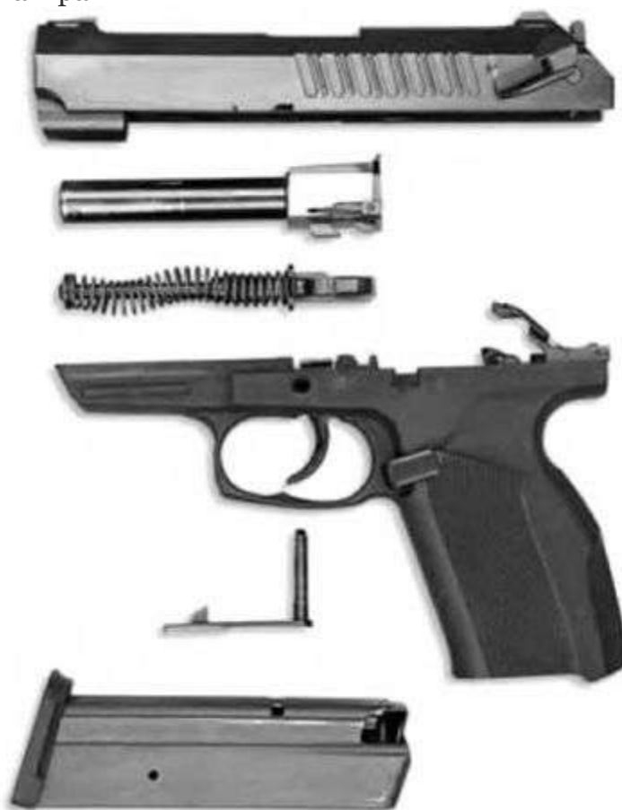
Неполная разборка пистолета МР-444 "Багира"
