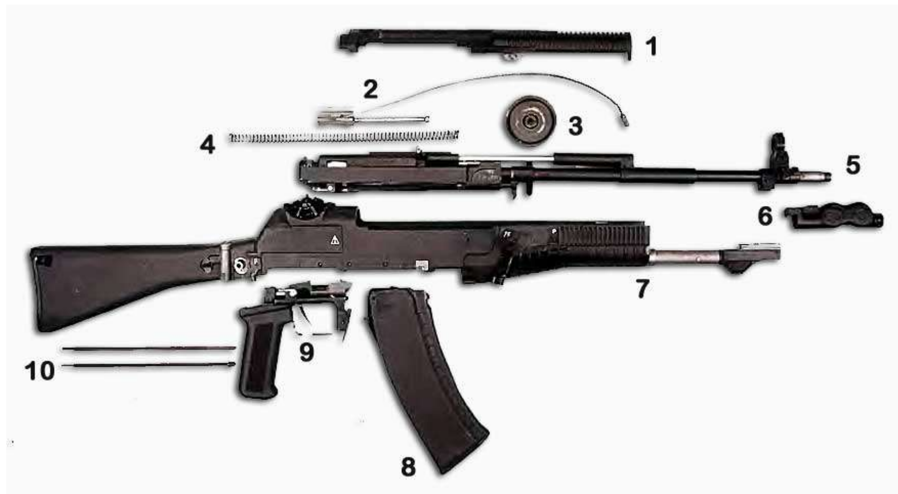
Автомат АН 94 в неполной разборке: 1 — крышка в сборе; 2 — подаватель (выталкиватель) с тросиком; 3 — ролик; 4 — пружина выталкивателя; 5 — стреляющий агрегат (ствол со ствольной коробкой, затворной рамой, затвором, ударным механизмом); 6 — дульный тормоз; 7 — кожух с прикладом; 8 — магазин; 9 — спусковой механизм с pistolетной рукояткой; 10 — шомпол и основание шомпола.
