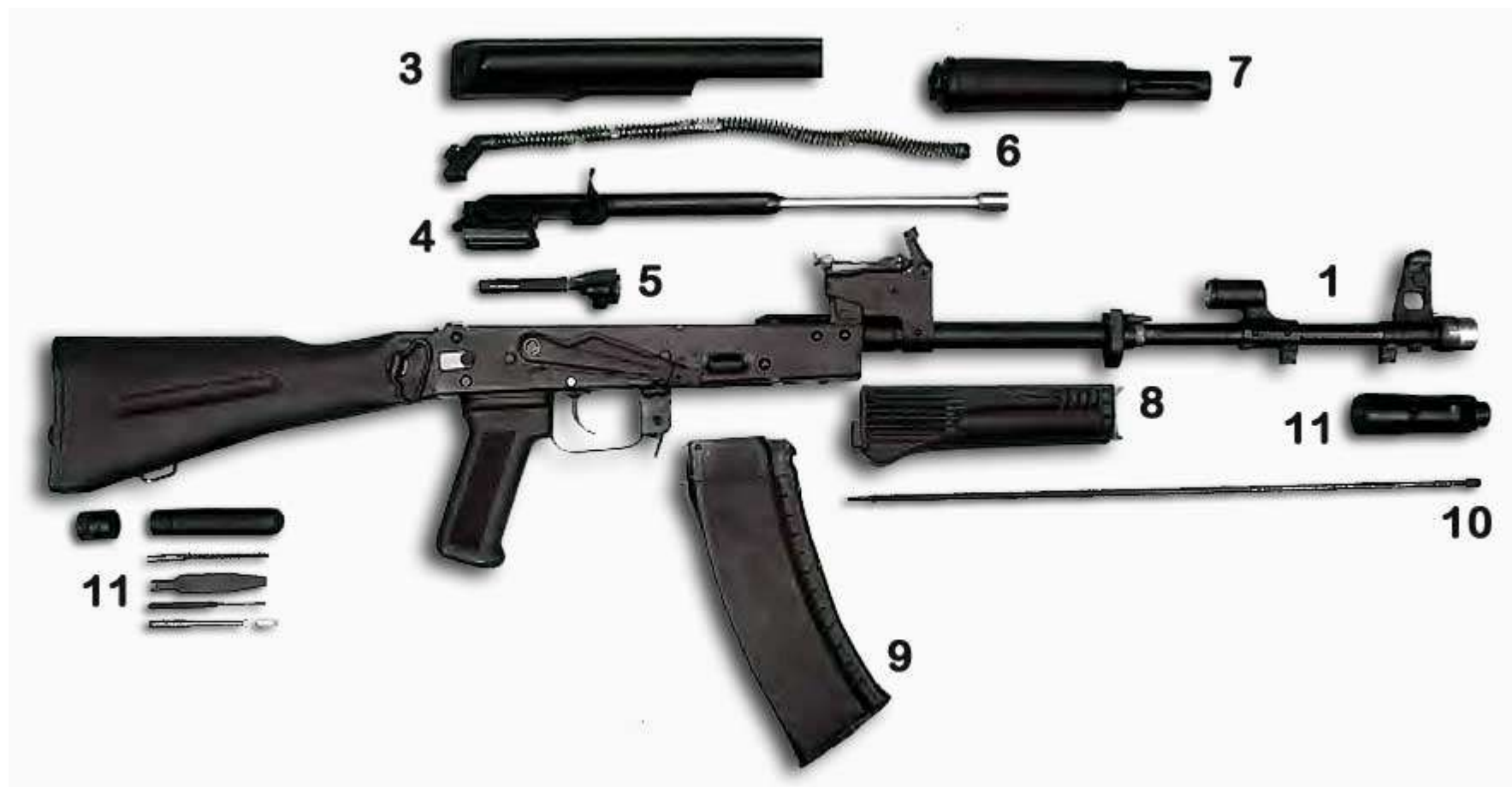
Автомат АК 101 в неполной разборке: 1 — ствол со ствольной коробкой с ударно-спусковым механизмом, прицельным приспособлением, прикладом и пистолетной рукояткой; 2 — дульный тормоз-компенсатор-пламегаситель; 3 — крышка ствольной коробки; 4 — затворная рама с газовым поршнем; 5 — затвор; 6 — возвратный механизм; 7 — газовая трубка со ствольной накладкой; 8 — цевье; 9 — магазин; 10 — шомпол; 11 — принадлежность.
