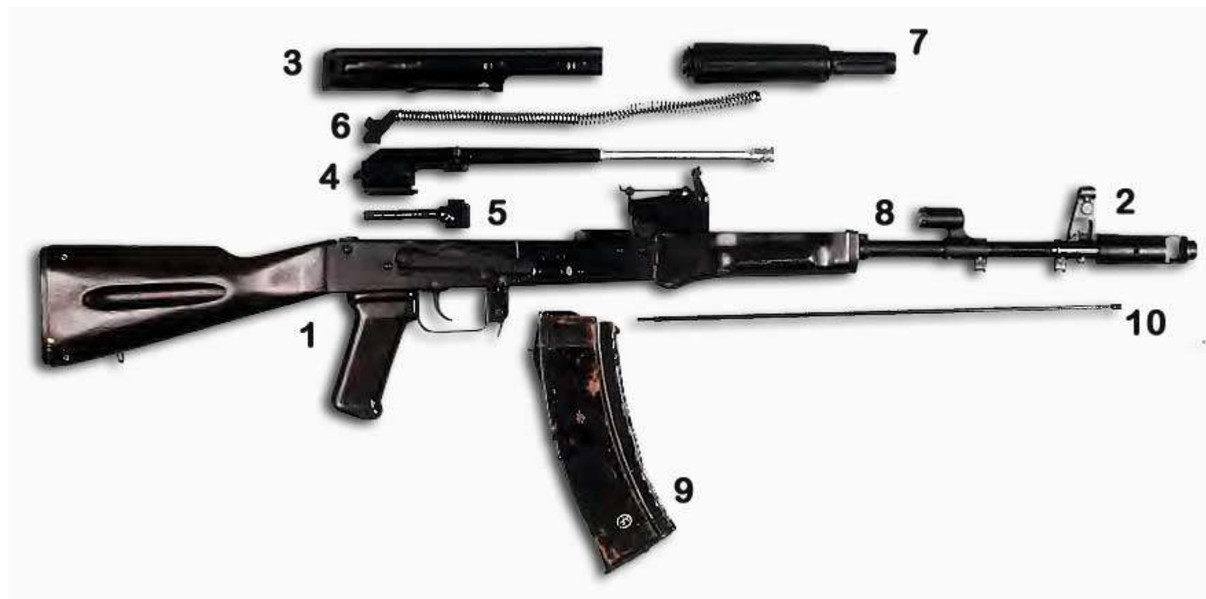
Автомат АК 74 в неполной разборке: 1 — ствол со ствольной коробкой с ударно-спусковым механизмом, прицельным приспособлением, прикладом и pistolетной рукояткой; 2 — дульный тормоз-компенсатор; 3 — крышка ствольной коробки; 4 — затворная рама с газовым поршнем; 5 — затвор; 6 — возвратный механизм; 7 — газовая трубка со ствольной накладкой; 8 — цевье; 9 — магазин; 10 — шомпол.
