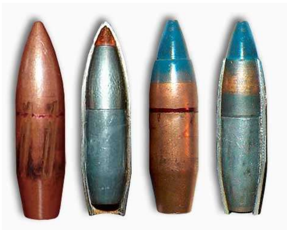
Устройство пуль снайперских патронов СП5 и 7Н9
