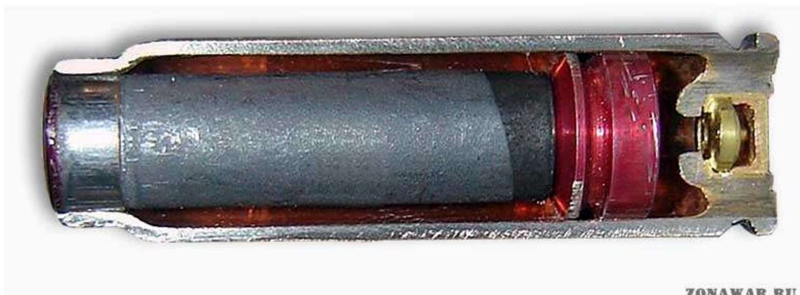
Устройство 7,62-мм пистолетного патрона СП4
