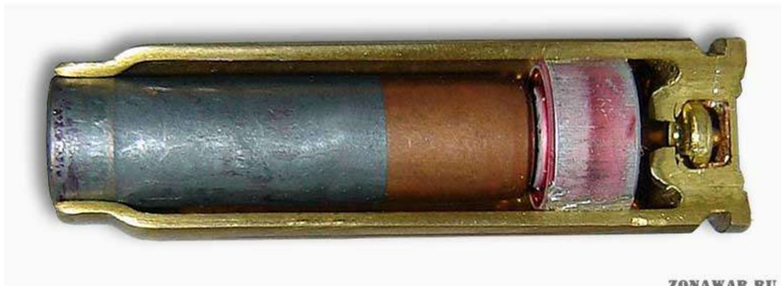
Устройство 7,62-мм pistolного патрона 7Н36
