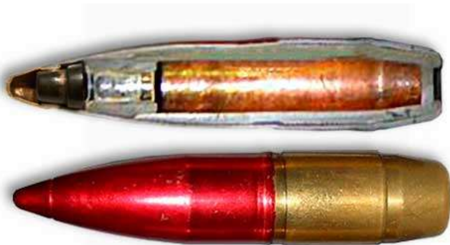
Зажигательная пуля мгновенного действия патрона 14,5 МДЗ
