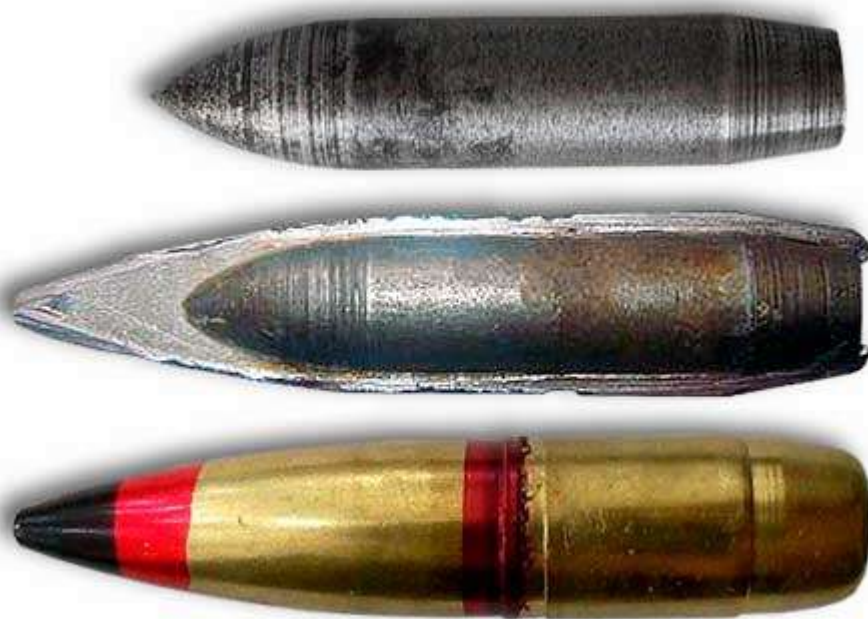
Бронебойно-зажигательная пуля патрона 14,5 Б-32
