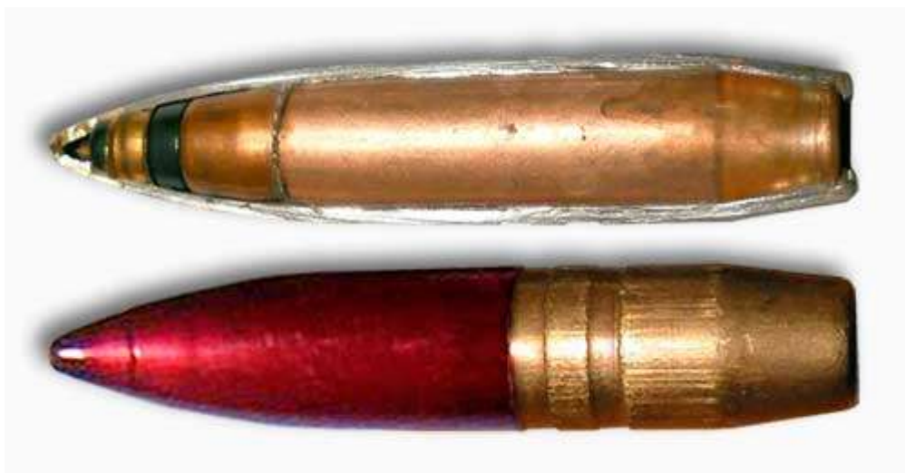
Зажигательная пуля мгновенного действия патрона 12,7 МДЗ
