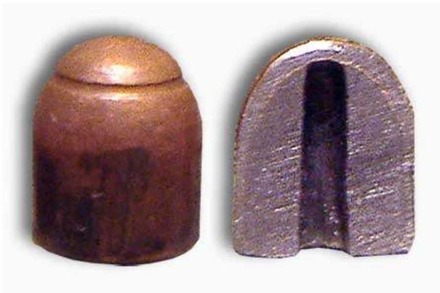
Пуля с пониженной рикошетирующей способностью 9 ПРС
