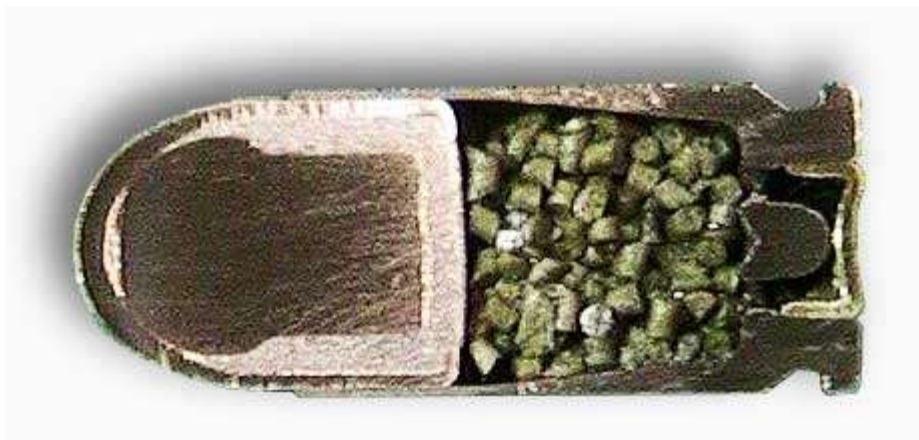
9x18 патрон с пулей со стальным сердечником 9 Пст в разрезе
