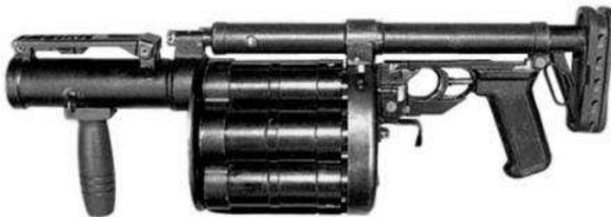
Гранатомет РГ-6 в транспортном положении (приклады прицел сложены).
