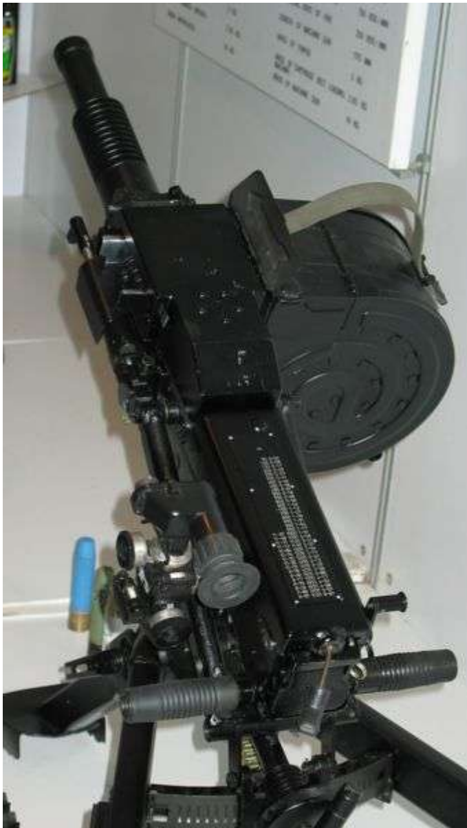
Вид на ствольную коробку и органы управления огнем гранатомета АГС-17.
