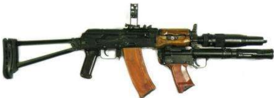
Бесшумный гранатометный комплекс БС1 "Канарейка" состоящий из автомата АКС-74УБ с глушителем ПБС-4 и подствольного гранатомета БС-1М. Гранатометный прицел поднят в положение для стрельбы гранатой.
