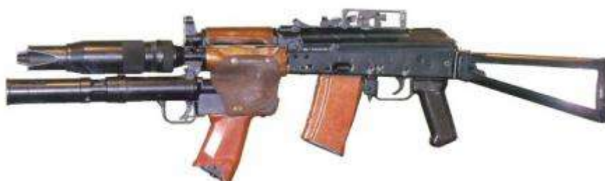
Бесшумный гранатометный комплекс "Канарейка": гранатомет БС-1М на автомате АКС-74УБ с глушителем ПБС-4.Кожаная накладка на цевье автомата служит для прикрытия кронштейна для установки гранатомета на цевье когда гранатомет снят с оружия. Автомат оснащен редким магазином на 20 патронов, гранатометный прицел сложен.
