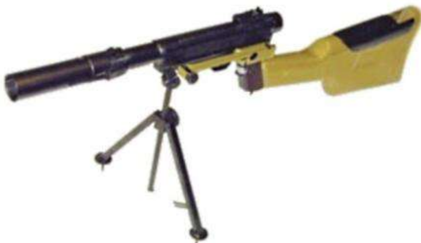
Бесшумный гранатомет / пистолет "Изделие Д" в положении для стрельбы гранатой, дополнительно установлены регулируемая сошка и гранатометный прицел.
