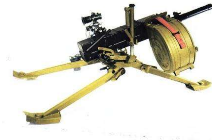
Гранатомет АГС-30 на пехотном станке. Вертикальная штанга справа от оружия несет в своей верхней части складную рукоятку для переноски оружия.
