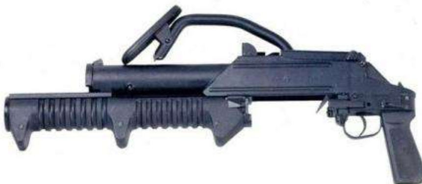
Гранатомет ГМ-94 со сложенным прикладом и открытым для перезарядки стволом.
