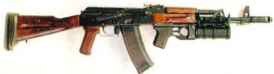
Подствольный гранатомет ГП-30 на автомате АК-74. На прикладе автомата установлен резиновый затыльник для уменьшения ощущаемой отдачи.
