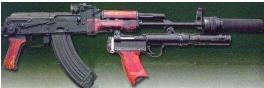
Бесшумный гранатометный комплекс "Тишина", состоящий из автомата АКМС с глушителем ПБС-1 и подствольного гранатомета БС-1 (РГА-86).
