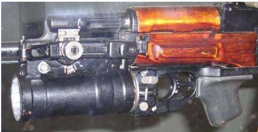
Подствольный гранатомет ГП-25, установленный на автомате АК-74. Прицел находится с левой стороны гранатомета.
