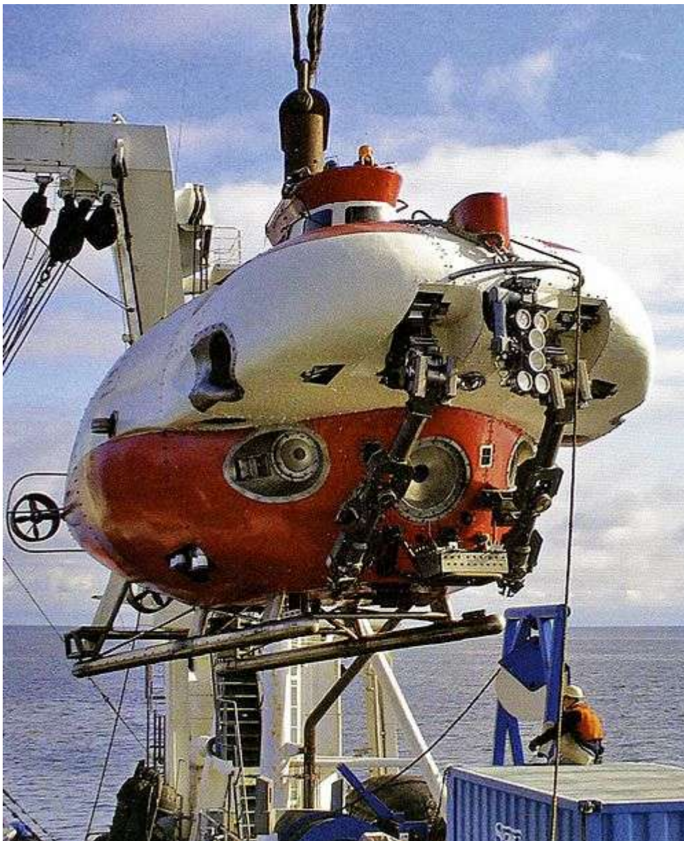
Автономный глубоководный аппарат АС-37 «Русь» проекта 16810.
