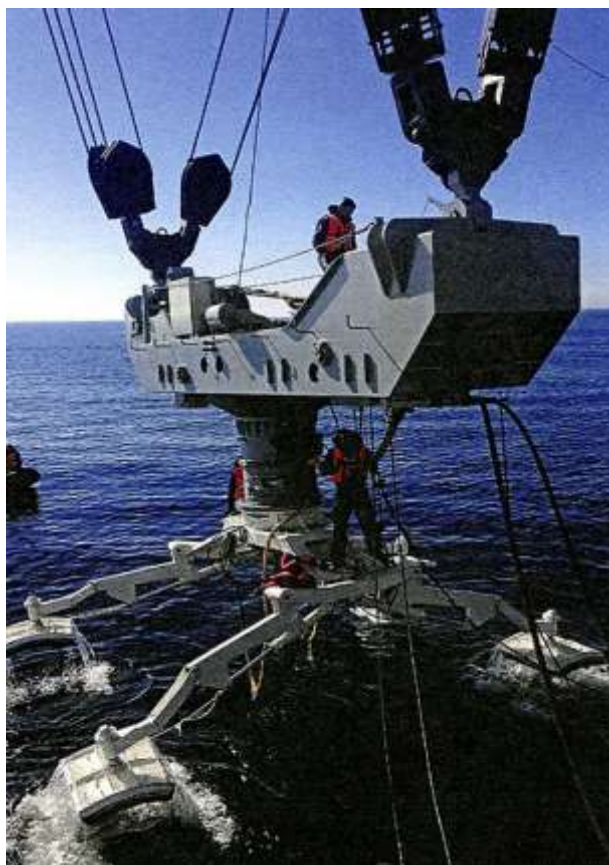
Спускоподъемное устройство.
