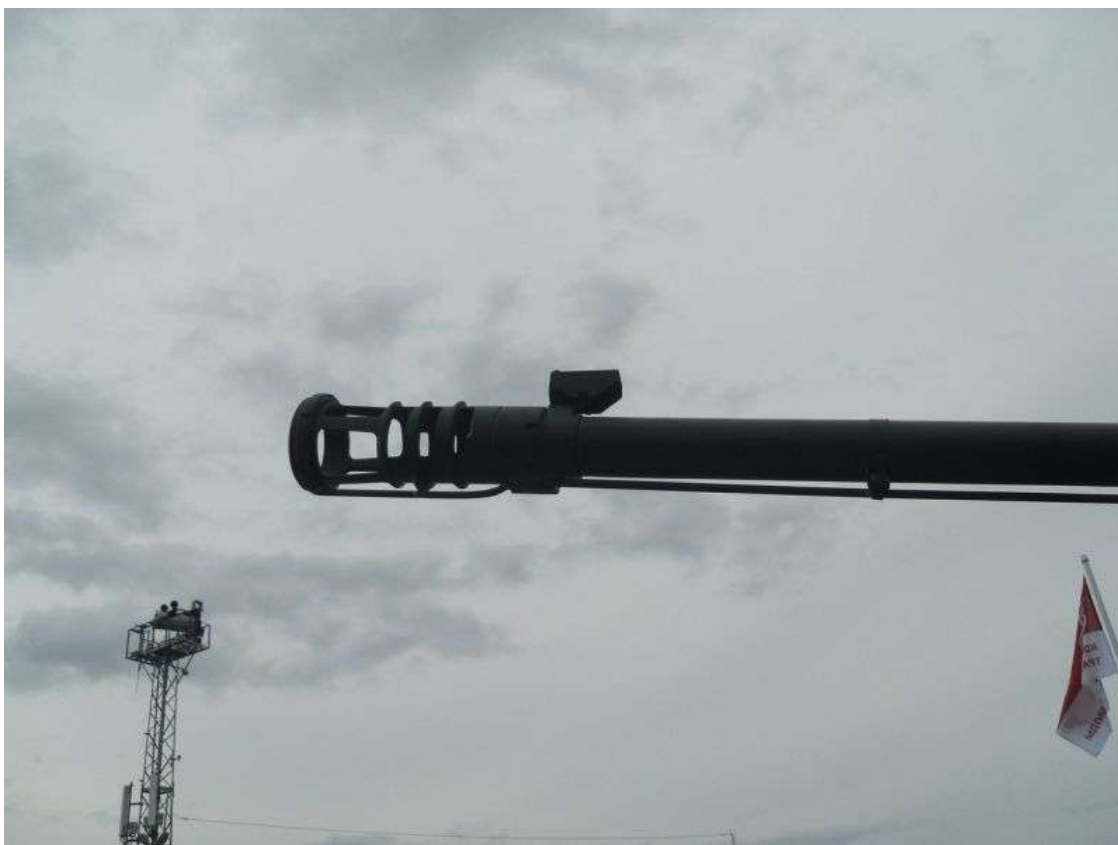
Надульное устройство пушки
