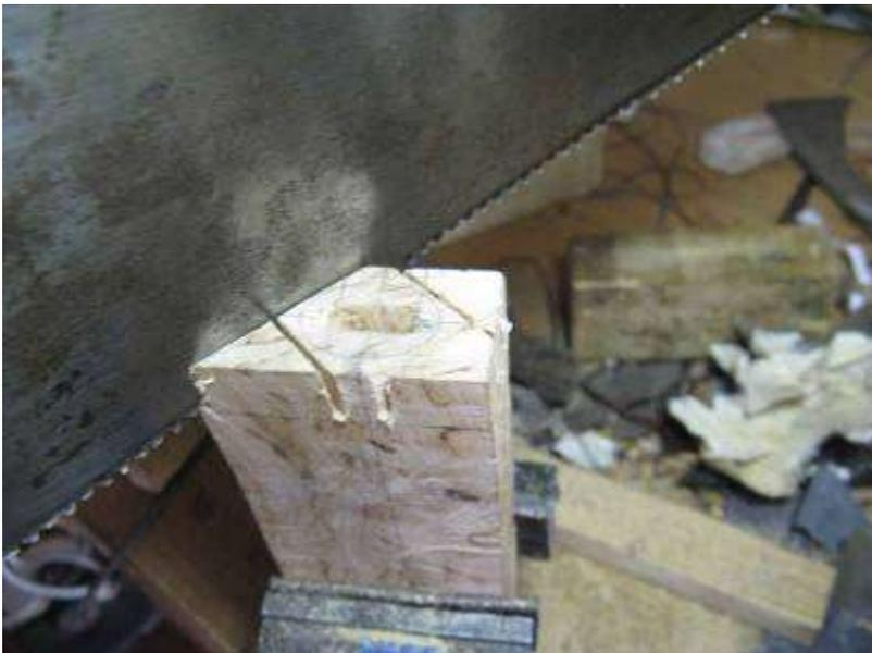
Далее обтачиваем получившийся "зуб" до тех пор пока на него не сядет оковка. Чтобы между оковкой и рукоятью не было заметно щели. Я этого добиваюсь шлифовкой плоскости перпендикулярной деревянному "зубу" (на который одевается оковка). Берём крупный надфиль и выводим эту плоскость, не забываем постоянно примерять оковку и отмечать те места где надо снять лишнее мясо. Когда начнёте делать, всё сразу станет ясно.
