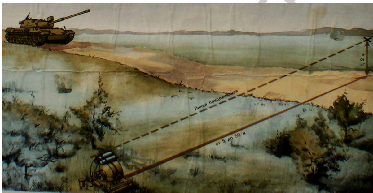
Рис. 18. Схема установки мины с взрывателем МВЭ-72 и обрывным датчиком мины ТМ-73:
